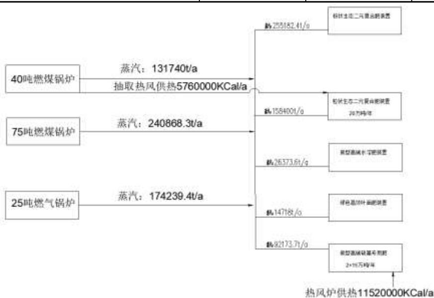
图3.2-2 热量平衡图
