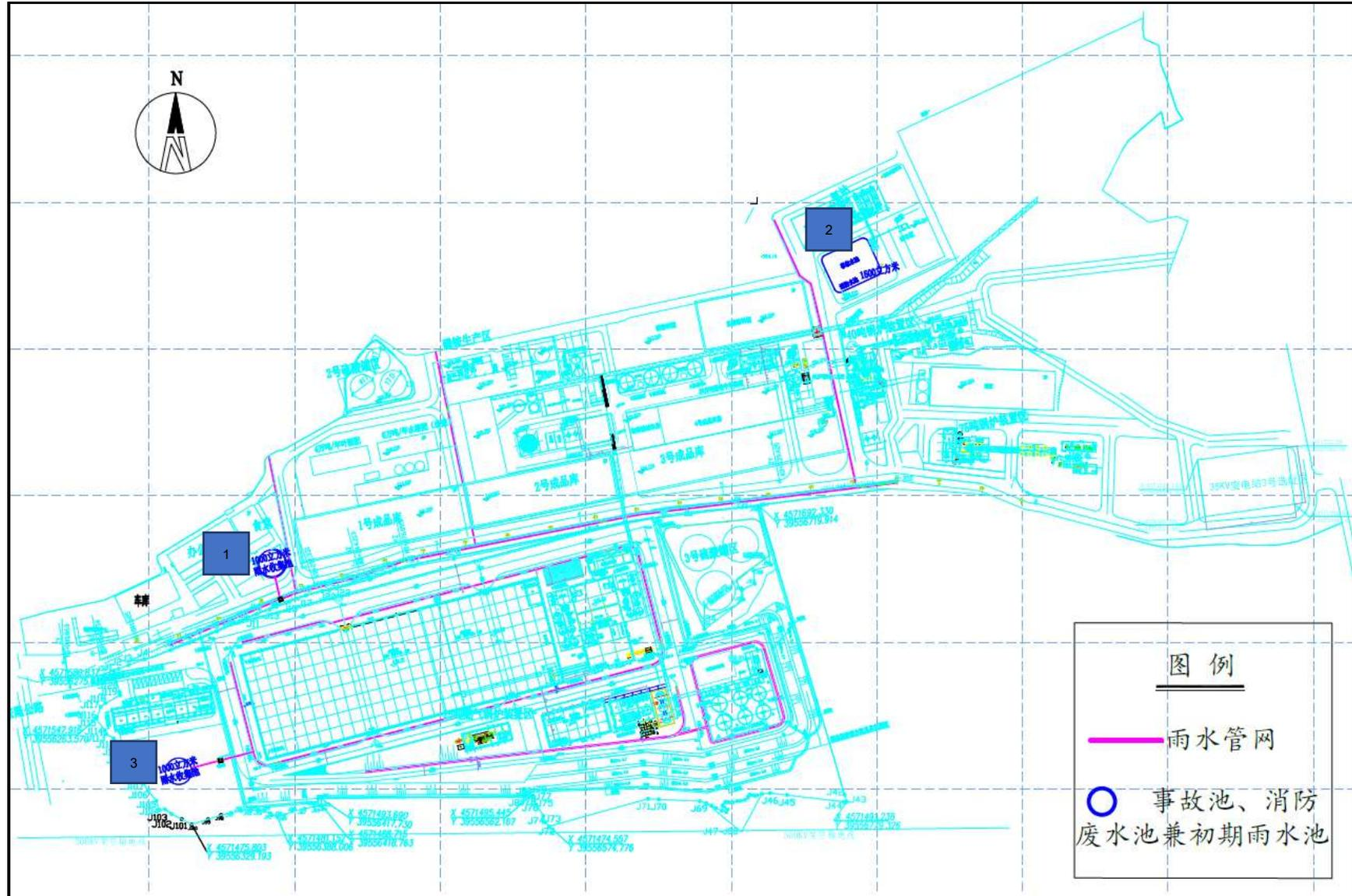
图5.2-118 事故水池、消防废水池及初期雨水池分布图（数字对应上表编号）
