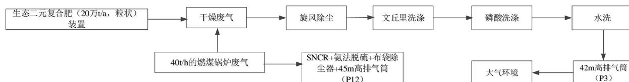
图6.2-4 生态二元复合肥（20 万 t/a，粒状）喷雾干燥废气流向图
