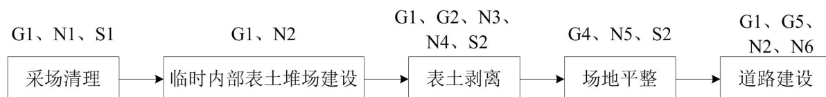
图 3.2-2 施工期主要工艺流程及排污节点图
