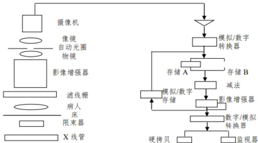
图 9-1 医用血管造影 X 射线机工作原理示意图
