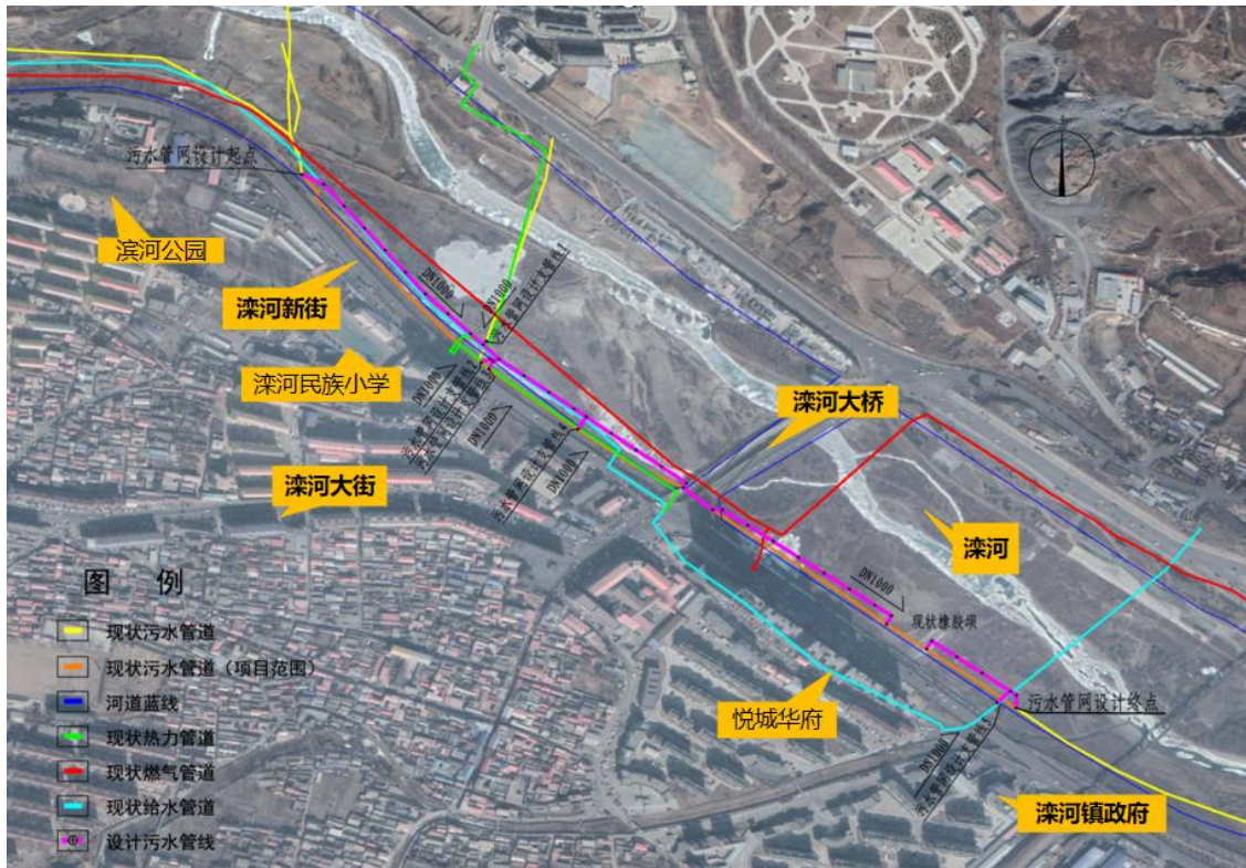
图 2-2 设计污水管线平面图
