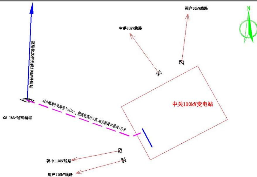
图 2-3 中关 110kV 变电站进线示意图
