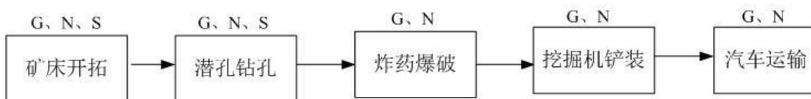
图 3-2 采区生产工艺流程图及排污节点（G 废气，W 废水，N 噪声，S 固废）
