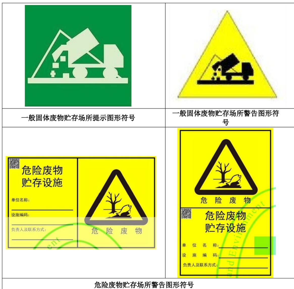
图 8-2 固体废物贮存场所图形符号类型及标志
