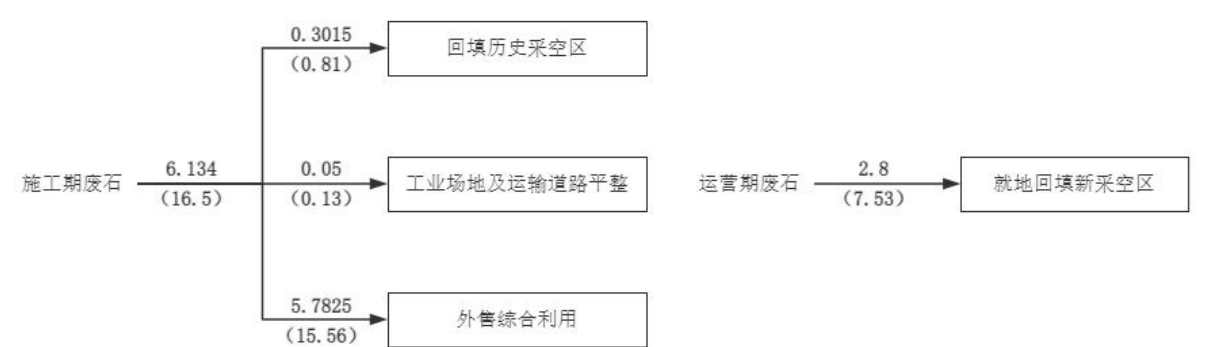
图 3.3-4 开采系统废石平衡图单位：万 m 3 （万 t）
