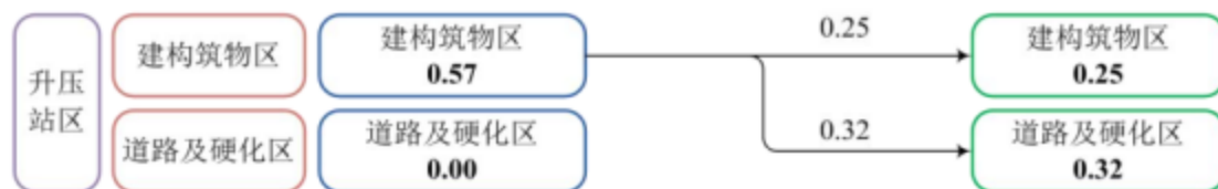
图2-2 升压站区域一般土石方平衡一览图
