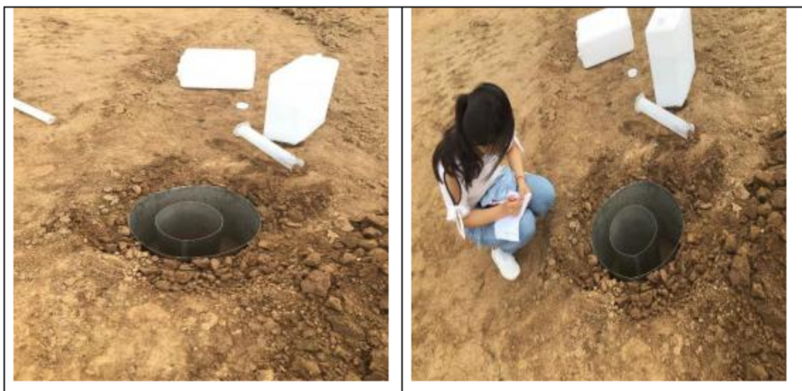
图 6.3-2 渗水试验现场
