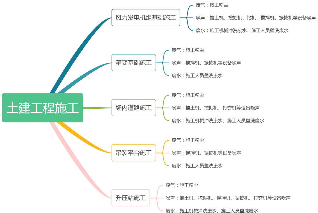
图 2-4 土建施工流程及产污节点图
