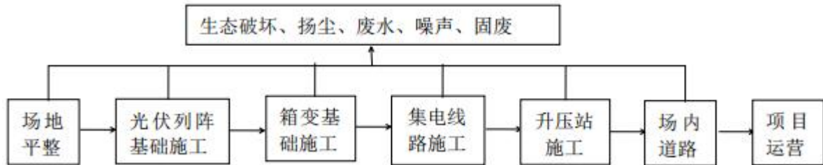
图 2-3 建设阶段工艺流程图
