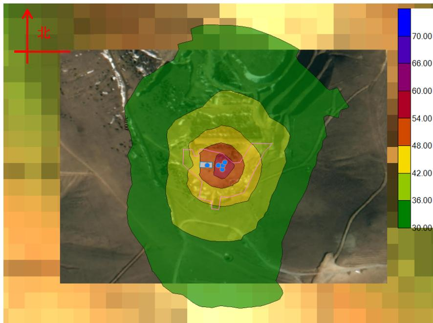
图4-2 项目1500m平硐口工业场地地面设备噪声贡献值等值线图
