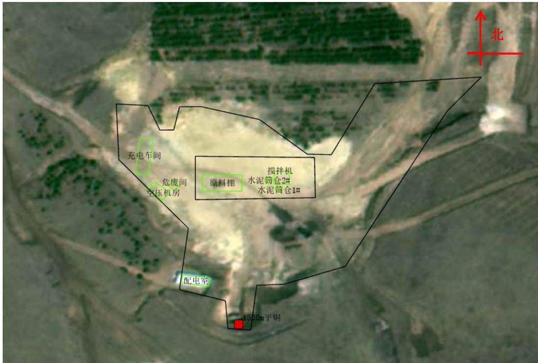
图2-7 1500m 平硐口工业场地平面布置示意图
