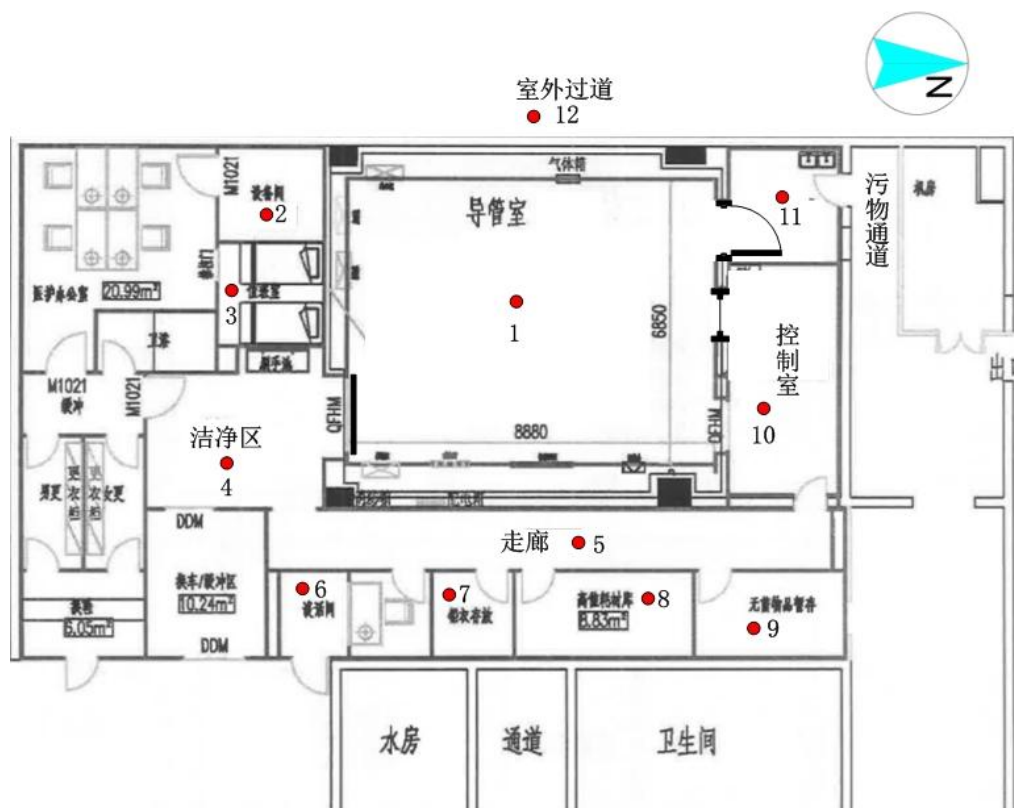
图 8-1 导管室 \gamma 辐射剂量率监测布点图
