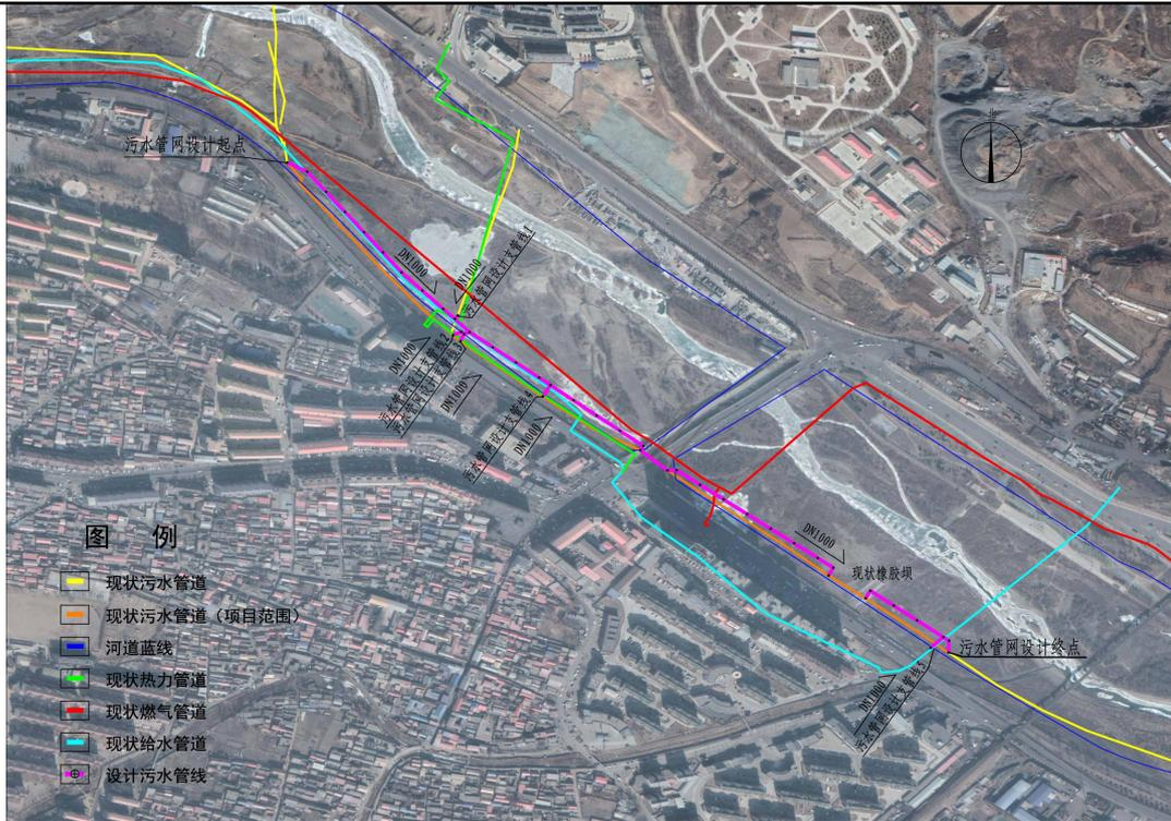
图 2-1 河道现状管线总平面图
