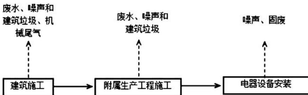
图 7 升压站施工工艺及产污节点图
