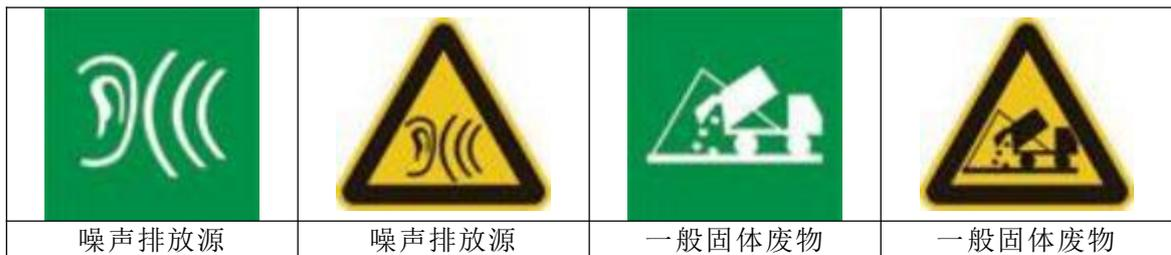
图 15 各种污染源的图形符号及标志形状、颜色
