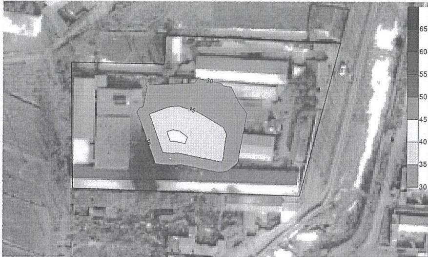
图4-2 拟建工程实施后厂界噪声等值线示意图
