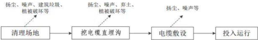
图 2-2 地下电缆施工流程图
